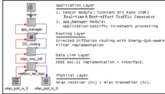
**Figure 15. Sensor Node Model**
